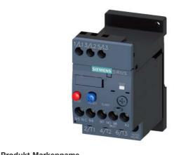
Überlastrelais 1,1...1,6 A thermisch für Motorschutz Baugröße S00, CLASS 10 Einzelaufstellung Hauptstromkreis: Schraub Hilfsstromkreis: Schraub Hand-Automatik-RESET
