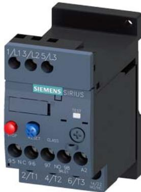
Überlastrelais 4,5...6,3 A thermisch für Motorschutz Baugröße S00, CLASS 10 Einzelaufstellung Hauptstromkreis: Schraub Hilfsstromkreis: Schraub Hand-Automatik-RESET
