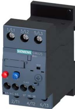
Überlastrelais 14...20 A thermisch für Motorschutz Baugröße S0, CLASS 10 Einzelaufstellung Hauptstromkreis: Schraub Hilfsstromkreis: Schraub Hand-Automatik-RESET
