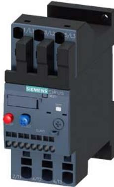
Überlastrelais 17...22 A thermisch für Motorschutz Baugröße S0, CLASS 10 Einzelaufstellung Hauptstromkreis: Federzugklemme Hilfsstromkreis: Federzugklemme Hand-Automatik-RESET
