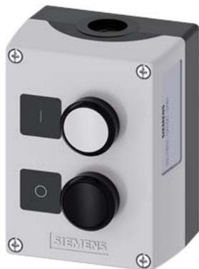
Gehäuse für Befehlsgeräte, 22 mm, rund, Gehäusematerial Kunststoff, Gehäuseoberteil grau, 2 Befehlsstellen Kunststoff, Vertiefung für Schilder, B=Drucktaster weiß, Schild: I, 1S, Schraubanschluss, A=Drucktaster schwarz Schild: O 1Ö, Schraubanschluss, Bodenbefestigung, Schilder beigelegt
