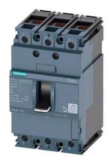
Leistungsschalter 3VA1 IEC Frame 100 Schaltvermögenklasse N Icu=25kA @ 415V 3-polig, Anlagenschutz TM210, FTFM, In=80A Überlastschutz Ir=80A fest eingestellt Kurzschlussschutz Ii=10 x In Klemmenanschluss Spannungsauslöser (STL) 220-250V DC, 208-277V AC 2 Hilfsschalter HQ 1 Ausgelöst-Meldeschalter HQ
