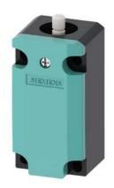
Basisschalter mit erhöhtem Korrosionsschutz für Positionsschalter 3SE513 Gehäuse Kunststoff nach DIN EN 50041 Geräteanschluss 1 x (M20 x 1,5) 1S/1Ö Schleichkontakte mit Überschneidung ohne Antriebskopf
