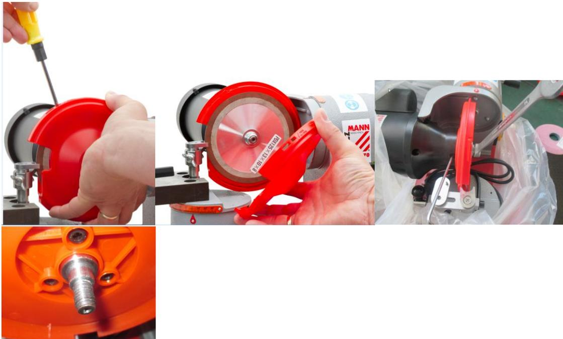
Montieren Sie den Adapter-Flansch und setzen Sie die Abdeckung wieder zusammen.
