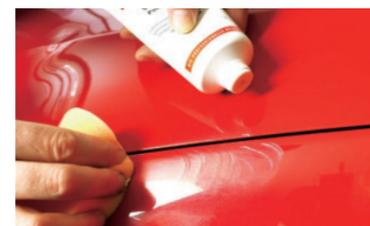
**4 SCHLEIFPASTE** oder auch Lackreiniger besitzen aggressive Schleifkörper und entfernen den stumpfen Lack. Vorsicht, auch die beiden tragen viel Lack ab, beide nur sparsam einsetzen.
