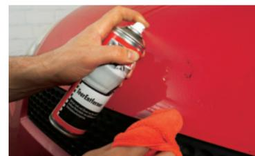
**2 LACK REINIGEN** Insekten, Teer und Baumharz sitzen hartnäckig auf dem Lack. Spezialreiniger lösen den Schmutz vom Blech und ermöglichen so erst ein perfektes Polierergebnis.
