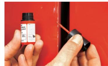
**8 LACK AUSBESSERN** Ist der Lack bis aufs Blech runter, zum Beispiel an den Türkanten (Bild), schützt ein Lackstift vor Rost und einer weiteren Unterwanderung des Lacks – schnell handeln!
