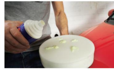
**7 SCHAUMSTOFFPAD** fürs Finish verwenden, die Drehzahl erhöhen und den Druck auf die Maschine reduzieren. Im Kreuzgang über den Lack gehen. Nie zu lange auf einer Stelle polieren.
