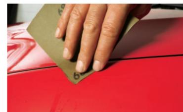
**3 SCHLEIFPAPIER** Ist ein Kratzer tief, aber noch im Klarlack, kann man ihn vorsichtig mit 800er- bis 1000er-Nassschleifpapier entfernen. Achtung, wer übertreibt, landet in der Grundierung.
