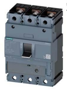
Leistungsschalter 3VA1 IEC Frame 250 Schaltvermögenklasse H Icu=70kA @ 415V 3-polig, Starterschutz TM120M, AM, In=200A ohne Überlastschutz Kurzschlussschutz Ii=6...14 x In Schraubenflachanschluss Unterspannungsauslöser (UVR) 120-127V AC 50/60Hz
