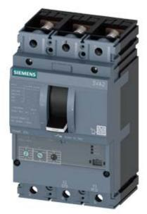
Leistungsschalter 3VA2 IEC Frame 250 Schaltvermögenklasse C Icu=110kA @ 415V 3-polig, Motorschutz ETU350M, LSI, In=200A Überlastschutz Ir=80A...200A Kurzschlussschutz Isd=3...15 x Ir, Ii=15 x In Schraubenflachanschluss Spannungsauslöser (STL) 110-127V DC, AC 50/60Hz 2 Hilfsschalter HQ
