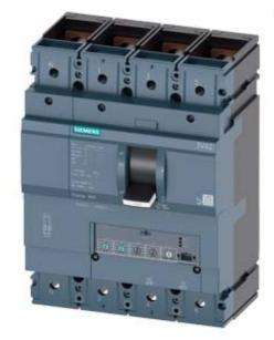
Leistungsschalter 3VA2 IEC Frame 400 Schaltvermögenklasse H Icu=85kA @ 415V 4-polig, Anlagenschutz ETU330, LIG, In=400A Überlastschutz Ir=160A...400A Kurzschlussschutz Ii=1,5...10 x In N-Leiterschutz einstellbar (OFF, 50%, 100%) Erdschlussschutz Ig=0,2...1 x In= tg=0,1/0,3s Schraubenflachanschluss
