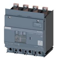
Differenzstrom-Schutzgerät RCD320 Basic RCD Typ A unten angebaut Bemessungsfehlerstrom 0,03...5A bei 50/60Hz tv unverzögert 4-polig In=160A Ue=100-480V Zubehör für: 3VA1
