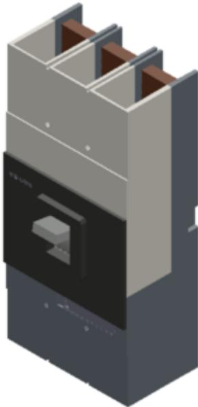
Leistungsschalter VL800L sehr hohes Schaltvermögen  $I_{cu}=100\text{kA}$ , 415V AC 3-polig, Anlagenschutz Überstromauslöser ETU10, LI  $I_n=800\text{A}$ , Bemessungsstrom  $I_R=320\dots800\text{A}$ , Überlastschutz,  $II=1,25$  bis 8 xIN, Kurzschlusschutz ohne Hilfsauslöser ETU kommunikationsfähig
