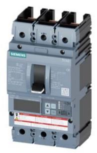
Leistungsschalter 3VA6 UL Frame 250 Schaltvermögenklasse C 100kA @ 480V 3-polig, Anlagenschutz ETU830, LIG, In=250A Überlastschutz Ir=100A...250A Kurzschlussschutz Ii=1,5...10 x In Erdschlussschutz Ig=0,2...1 x In, tg=0,05-0,8s ohne Anschluss
