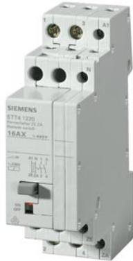
Fernschalter mit 2 Schließern, mit zentral Ein-aus Funktion Kontakt für AC 230V, 400V 16A Ansteuerung AC 24V
