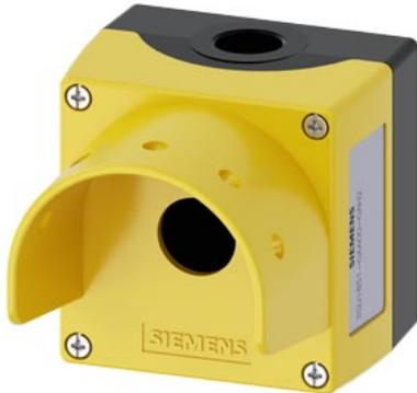
Gehäuse für Befehlsgeräte, 22 mm, rund, Gehäusematerial Metall, Gehäuseoberteil gelb, mit Schutzkragen für 5 Vorhängeschlösser und Pilzdurchmesser 60 mm, 1 Befehlsstelle, ohne Bestückung, Bodenbefestigung, oben und unten je 1xM20
