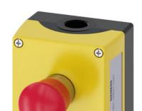
Gehäuse für Befehlsgeräte, 22 mm, rund, Gehäusematerial Metall, Gehäuseoberteil gelb, 1 Befehlsstelle Metall, A=NOT-HALT-Pilzdrucktaster rot, 40 mm, drehentriegelt, Befehlsstelle mittig, 2Ö, Schraubanschluss, Bodenbefestigung, oben und unten je 1xM20
