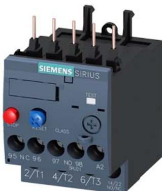
Überlastrelais 0,35...0,50 A thermisch für Motorschutz Baugröße S00, CLASS 10 Schützenbau Hauptstromkreis: Schraub Hilfsstromkreis: Schraub Hand-Automatik-RESET
