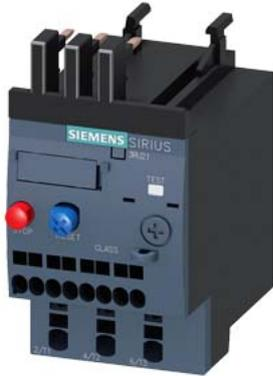
Überlastrelais 1,1...1,6 A thermisch für Motorschutz Baugröße S00, CLASS 10 Schützenbau Hauptstromkreis: Federzugklemme
