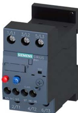
Überlastrelais 17...22 A thermisch für Motorschutz Baugröße S0, CLASS 10 Einzelaufstellung Hauptstromkreis: Schraub Hilfsstromkreis: Schraub Hand-Automatik-RESET
