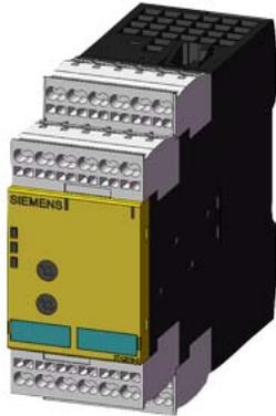
SIRIUS Sicherheitsschaltgerät sicherheitsgerichtete Stillstandsüberwachung AC 400 V, 45 mm Federzugklemme FK unverzögert: 3 S + 1 Ö FK verzögert: 0 MK: 3 Auto-Start Grundgerät max. Fehler-Kat. EN 954-1: 4 maximal erreichbarer PL nach EN 13849-1: e maximal erreichbarer SIL nach IEC 61508: 3
