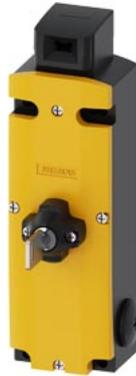
Sicherheits-Positionsschalter mit Zuhaltung Zuhaltkraft 2600 N 5 Anfahrichtungen Federkraftverriegelt Hilfsentriegelung mit Schloss Magnetspannung AC 230 V Überwachung Betätiger 2Ö/1S Überwachung Magnet 2Ö/1S Lieferung ohne Betätiger. Betätiger 3SE5000-0AV0. bitte separat bestellen
