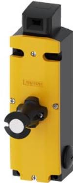
Sicherheits-Positionsschalter mit Zuhaltung Zuhaltkraft 2600 N 5 Anfahrichtungen Federkraftverriegelt Fluchtentriegelung von vorne Magnetspannung AC 115 V Überwachung Betätiger 2Ö/1S Überwachung Magnet 2Ö/1S Lieferung ohne Betätiger. Betätiger 3SE5000-0AV0. bitte separat bestellen
