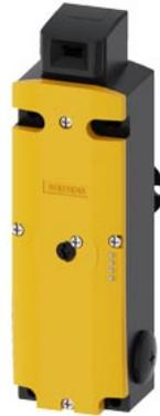
Sicherheits-Positionsschalter mit Zuhaltung Zuhaltkraft 2600 N 5 Anfahrichtungen Federkraftverriegelt Notentsperrung hinten und Hilfsentriegelung vorne Magnetspannung DC 24 V Überwachung Betätiger 2Ö/1S Überwachung Magnet 2Ö/1S LED-Anzeige gelb/grün Lieferung ohne Betätiger. Betätiger 3SE5000-0AV0.
