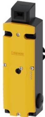
Sicherheits-Positionsschalter mit Zuhaltung Zuhaltkraft 2600 N 5 Anfahrichtungen Federkraftverriegelt Fluchtentriegelung von hinten und Hilfsentriegelung vorne Magnetspannung AC 115 V Überwachung Betätiger 2Ö/1S Überwachung Magnet 2Ö/1S LED-Anzeige gelb/grün Lieferung ohne Betätiger. Betätiger 3SE5000-0AV0. bitte separat bestellen
