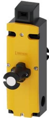
Sicherheits-Positionsschalter mit Zuhaltung Zuhaltkraft 1300 N 5 Anfahrichtungen Federkraftverriegelt Notentsperrung hinten und Fluchentriegelung vorne Magnetspannung DC 24 V Überwachung Betätiger 2Ö/1S Überwachung Magnet 2Ö/1S Einsatz für -40 °C Schock- und Schwingprüfung nach DIN EN 61373 Betätiger 3SE5000-0AV../0AW.. bitte separat bestellen
