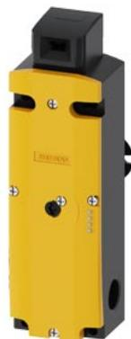
Sicherheits-Positionsschalter mit Zuhaltung Zuhaltkraft 1300 N 5 Anfahrichtungen Federkraftverriegelt Fluchtrückriegelung von hinten und Hilfsentriegelung vorne Magnetspannung AC 115 V Überwachung Betätiger 2Ö/1S Überwachung Magnet 2Ö/1S LED-Anzeige gelb/grün Lieferung ohne Betätiger. Betätiger 3SE5000-0AV0. bitte separat bestellen
