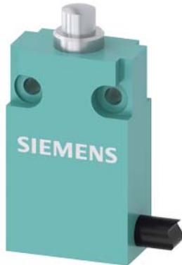
Positionsschalter in Kompaktbauform 30 mm breit mit Anschlussleitung 2 m Sprungschaltglieder 1S+1Ö Kuppenstößel
