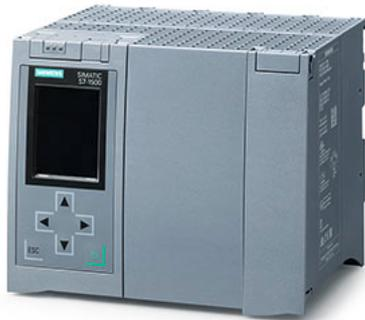
SIMATIC S7-1500F, CPU 1518F-4 PN/DP, Zentralbaugruppe mit Arbeitsspeicher 9 MByte für Programm und 60MByte für Daten, 1. Schnittstelle: PROFINET IRT mit 2 Port Switch, 2. Schnittstelle: PROFINET RT, 3. Schnittstelle: PROFINET Basisdienste, 4. Schnittstelle: PROFIBUS, 1 NS Bit-Performance, SIMATIC Memory Card notwendig
