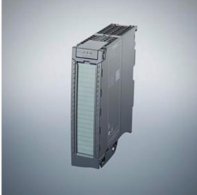
SIMATIC S7-1500, Digitalausgabemodul DQ 16xAC 230V/1A ST; TRIAC; 16 Kanäle in Gruppen zu 2; 2A pro Gruppe; Ersatzwert: Frontstecker (Schraubklemmen oder Push-In) separat bestellen
