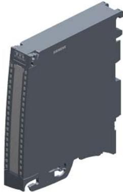
SIMATIC S7-1500, Analogeingabemodul AI 4xU/I/RTD/TC ST, 16 Bit Auflösung, Genauigkeit 0,3%, 4 Kanäle in Gruppen zu 4, 2 Kanäle bei RTD Messung, Gleichtaktspannung 10V; Diagnose; Prozessalarme; Lieferung inklusive Frontstecker Push-In, Einspeiseelement, Schirmbügel, und rnklemme
