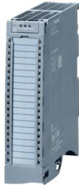
SIMATIC S7-1500, Analogausgabemodul AQ 4xU/I HF, 16 Bit Auflösung, Genauigkeit 0,1%, 4 Kanäle in Gruppen zu 1, Gleichtaktspannung: 30V AC/60V DC, Diagnose; Ersatzwert, Taktsynchronität; Baugruppe unterstützt das sicherheitsgerichtete Abschalten von Lastgruppen bis zu SIL2 gemäß EN IEC 62061:2021 und Category 3 / PL d gemäß EN ISO 13849-1:2015. Lieferung inklusive Einspeiseelement, Schirmbügel und Schirmklemme: Frontstecker (Schraubklemmen oder Push-In) separat bestellen
