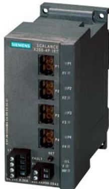
SCALANCE X200-4PIRT managed IE IRT Switch, 4x 100 Mbit/s POF SC RJ Ports, Fehlermeldekontakt mit Set- Taster, redundante Spannungsversorgung, PROFINET IO Device, Netzwerk-Management, Redundanz-Manager integriert, inkl. elektron. Handbuch auf CD-ROM, C-PLUG optional.
