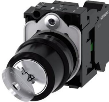
Schlüsselschalter RONIS, 22 mm, rund, Kunststoff, Schließ-Nr. SB30, mit 2 Schlüsseln, 2 Schaltstellungen O-I, verrastend, 10:30h/13:30h, Schlüsselabzug O+I, mit Halter, 1S, Federzuganschluss, mögliche Sonderschließungen: SB31, 421, 455
