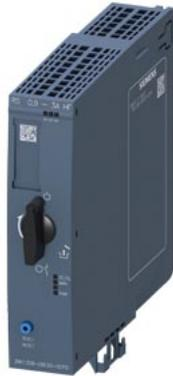
Wendestarter High Feature; elektronisch schaltend; elektronischer Überlastschutz bis 1,1kW / 400V; Einstellbereich 0,9 .. 3A; PROFInergy; Option: 3DI/LC-Modul
