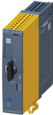
Fehlersicherer Direktstarter High Feature; elektronisch schaltend; elektronischer Überlastschutz bis 4kW / 400V; Einstellbereich 2,8 .. 9A; PROFIenergy; Option: 3DI/LC-Modul
