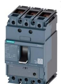
Leistungsschalter 3VA1 IEC Frame 160 Schaltvermögenklasse M Icu=55kA @ 415V 3-polig, Starterschutz TM120M, AM, In=125A ohne Überlastschutz Kurzschlussschutz Ii=5...15 x In Schraubenflachanschluss 2 Hilfsschalter HP
