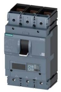
Leistungsschalter 3VA2 IEC Frame 630 Schaltvermögenklasse H Icu=85kA @ 415V 3-polig, Anlagenschutz ETU550, LSI, In=630A Überlastschutz Ir=250A...630A Kurzschlussschutz Isd=0,6..9 x In, Ii=1,5..9 x In N-Leiterschutz optional mit externem Stromwandler, bis 160% Schraubenflachanschluss Unterspannungsauslöser (UVR) 208-230V AC 50/60Hz
