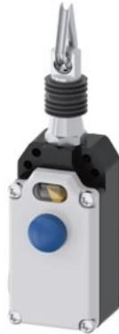
Seilzugschalter Metallgehäuse, 2x M20 x1,5; 2Ö, mit Verrastung EN ISO 13850 und Druckknopfentriegelung für Seillängen bis 5 m
