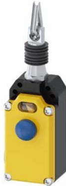
Seilzugschalter Metallgehäuse, 2x M20 x 1,5; mit gelbem Deckel, 2Ö/1S, mit Verrastung EN ISO 13850 und Druckknopfentriegelung für Seillängen bis 5 m
