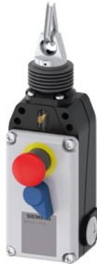
Seilzugschalter mit Not-Halt Metallgehäuse IP67, 3 xM20 x1,5; Schleichschaltglieder 1S+3Ö; Verrastung nach EN ISO 13850, mit Drehentriegelung, für Seillängen bis 75 m
