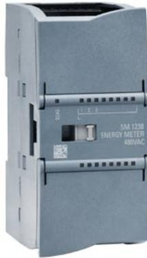
SIMATIC S7-1200, Analogeingabe, SM 1238 Energy Meter 480V AC, Energiemessmodul zur Daten- erfassung in 1-und 3-Phasen- Netzen (TN, TT) bis 480V AC; Strombereich: 1A, 5A; Erfassung von Spannung, Strom, Phasenwinkeln, Leistung, Energiewerten, Frequenzen; Kanaldiagnose
