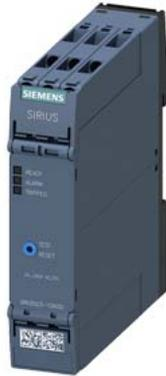
Thermistor-Motorschutzrelais Gerät für Warnen und Abschalten 22,5 mm Gehäuse Schraubanschluss 1 Schliesser + 1 Wechsler US = AC/DC 24 V-240 V Hand/Auto/Fern-RESET mit ATEX-Zulassung 3 LEDs (READY/WARNING/TRIPPED) sichere galvanische Trennung Test-/RESET-Taste Drahtbruchüberwachung Kurzschlussüberwachung nullspannungssicher 2 getrennte PTC-Fühlerkreise
