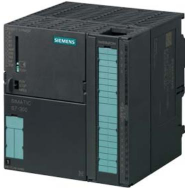
SIMATIC S7-300, CPU 315T-3 PN/DP, Zentralbaugruppe für SPS- und Technologieaufgaben, 384 KByte Arbeitsspeicher, 1. SS MPI/DP 12MBit/s, 2. SS DP (Drive), 3. SS Ethernet PROFINET mit 2 Port Switch, integr. I/O für Technologie, Frontstecker (1x 40-polig) und Micro Memory Card min. 8 MB erforderlich
