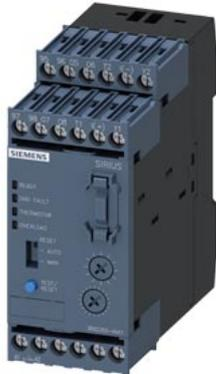
Auswerteeinheit für Motorvollschutz (bistabil) Baugröße S00...S12, CLASS 5...30 Einzelaufstellung Hauptstromkreis: -- Hilfsstromkreis: Schraubanschl. Hand-Automatik-RESET
