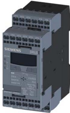
Temperaturüberwachungsrelais für IO-Link PT100/1000, KTY83/84, NTC 1 bis 3 Fühler, 2 Grenzwerte -50 °C bis 750 °C 3 x 1 W, Breite 45 mm Federzuganschluss !!!Auslaufprodukt!!! Der präferierte Nachfolger ist 3RS2800-2BA40+3RS2900-2AA30
