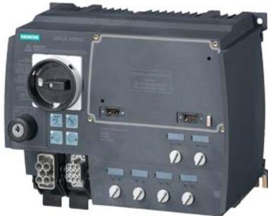
SIRIUS Motorstarter M200D Technologiemodul Reversierstarter elektronisch schaltend AC-3, 5,5 kW / 400 V 1,5 A...12,00 A elektronischer Überlastschutz Thermistor: THERMOCLICK / PTC ohne Bremskontakt 4DI / 2DO Han Q4/2 - Han Q8/0 mit Hand-vor-Ort Bedienung und Schlüsselschalter mittels Kommunikationsmodul 3RK1305\* verwendbar an PROFIBUS oder PROFINET
