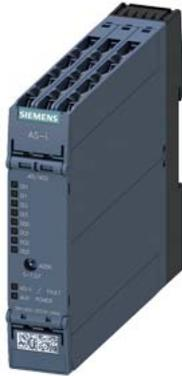
AS-i SlimLine Compact Modul SC22.5 digital 4DI/4DQ, IP20 4 x Eingang für 3-Leiter Sensor Sensorversorgung umschaltbar 4 x Ausgang, 2 A, DC 24 V maximal 4 A für alle Ausgänge Schraubklemmen Baubreite 22,5 mm
