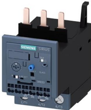
Überlastrelais 20...80 A elektronisch für Motorschutz Baugröße S2, CLASS 10E Schützenbau Hauptstromkreis: Schraub Hilfsstromkreis: Federzugklemme Hand-Automatik-RESET
